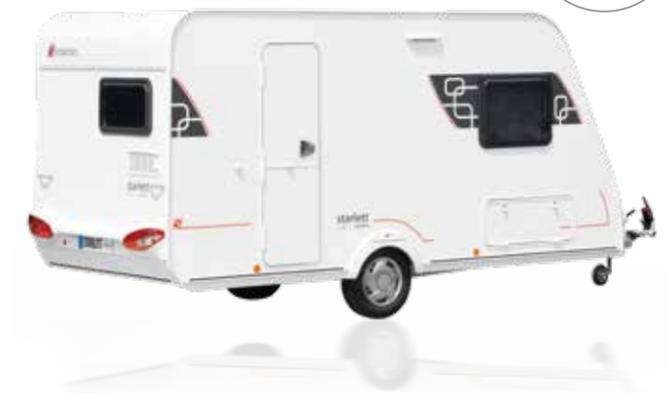
Ein komplett ausgerüsteter Starlett dank dem Comfort – Paket; mit u.a. AKS-Schlingerkupplung 3004, Stoßdämpfer, Serviceklappe, Dachhaube, Abwassertank, Truma Therme und „Komfort“-Kaltschaummatratze. Mit GfK-(Polyester)-Fronten und einem abgerundeten Bugkasten bietet dieser STARLETT „COMFORT“ ebenfalls ein kontrastreiches modernes Außendesign. Mit seinem geringen Gewicht und seiner Wendigkeit kann die STARLETT „COMFORT“ von den meisten Fahrzeugen leicht gezogen werden.
